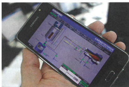
Per Smartphone lässt sich die Feuerung im Staubbrenner überwachen und steuern. Bild: Carbotechnik
